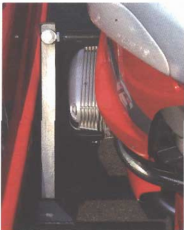
Angedockt: Die Verbindung zwischen Bike und Boot erfolgt über drei Streben.
